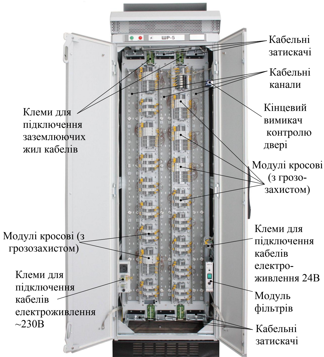
Рисунок 2.15 – Зовнішній вигляд шафи розподільчої ШР-5
