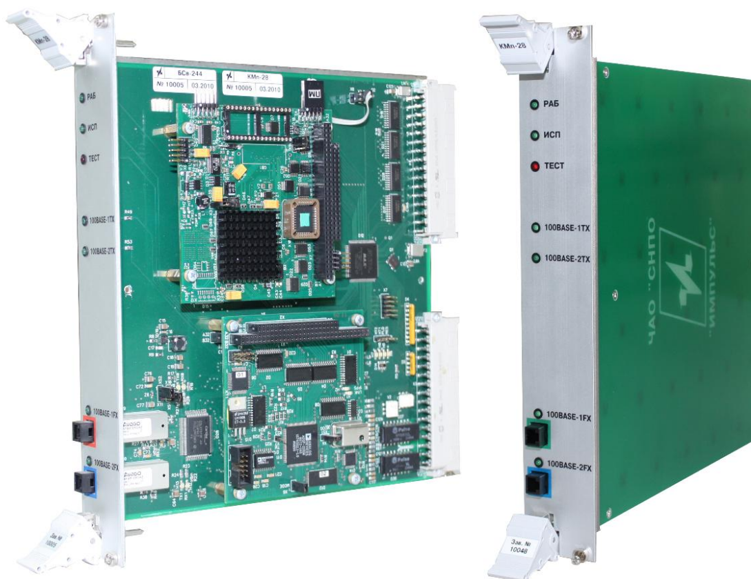
Рисунок 2.11 – Загальний вид модуля КМп
